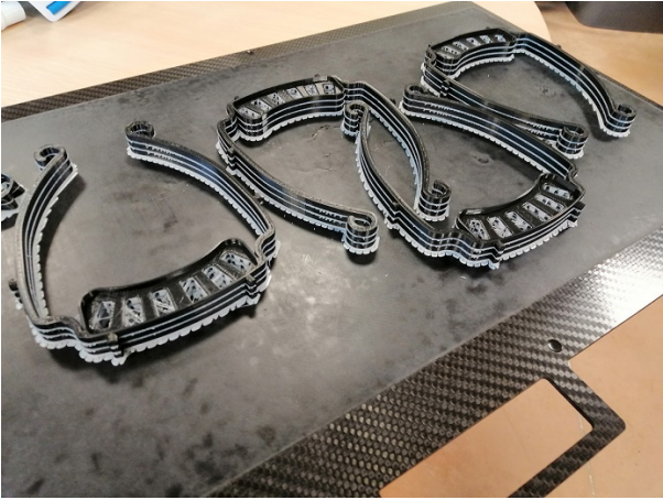
adaptateur masque en cours d'impression sur TEVO imprimées
