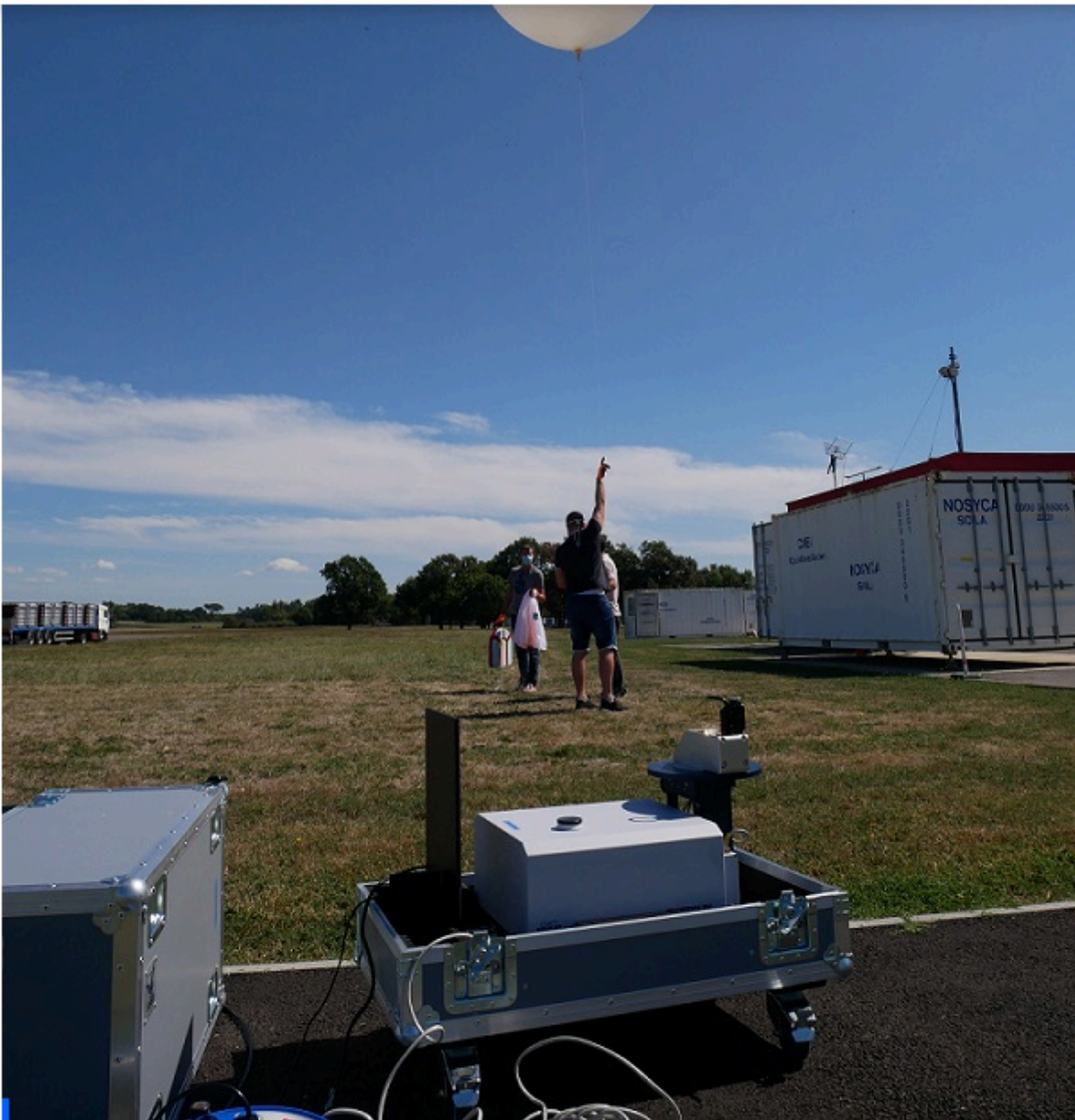
Lâcher de l'instrument AirCore sous ballon léger dilatable depuis le site d'Aire-sur-l'Adour du CNES en 2020. L'instrument AirCore prélève une carotte d'air, qui sera ensuite analysée. Au premier plan : un spectromètre EM27/S © Cyril Crevoisier
