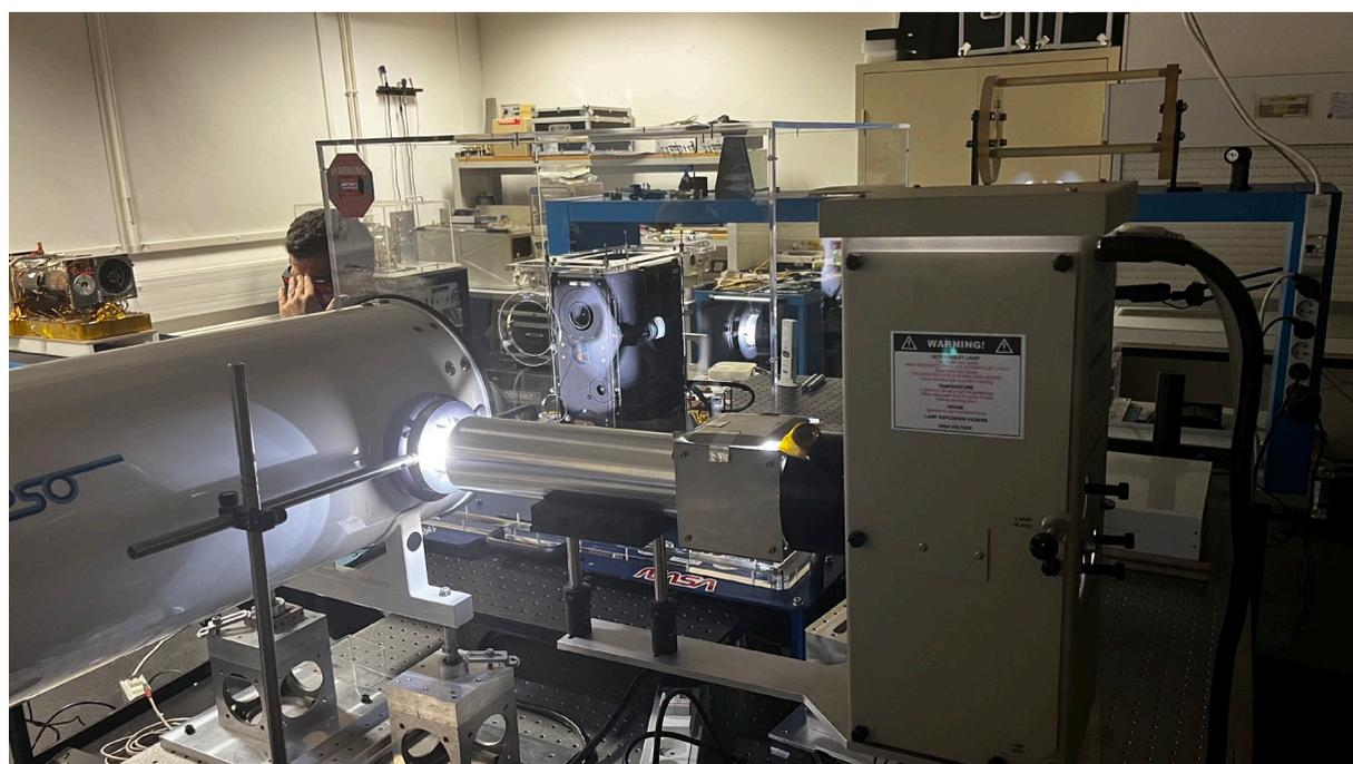
*Essais d'étalonnage des instruments du satellite UVSQ-SAT NG.*
