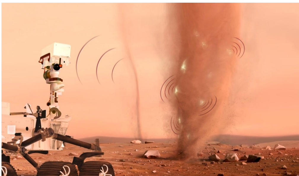
Détection de décharges électriques dans les tourbillons de poussière par l'instrument SuperCam, embarqué sur le rover martien Perseverance
