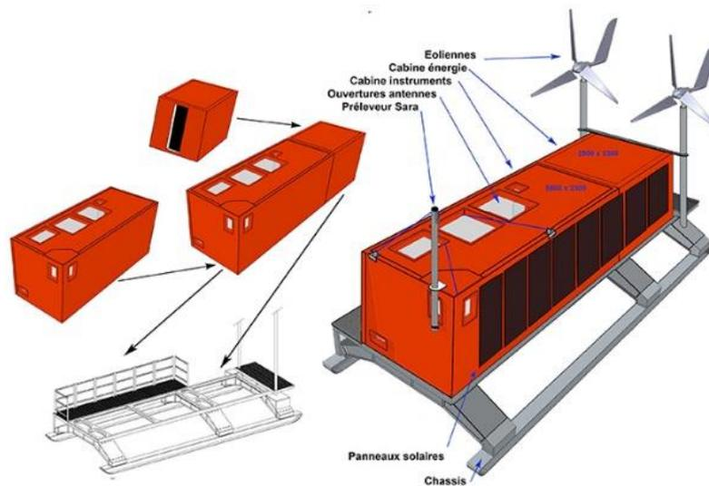
**Représentation d'une plateforme d'observation.** Quatre de ces plateformes seront installées le long de l'axe ciblé par le projet AWACA. Chaque plateforme contient une batterie d'instruments capables d'effectuer des mesures *in situ* de l'atmosphère.
