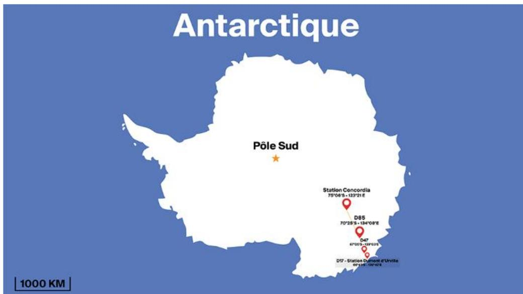
**Axe de 1 100 km le long duquel seront déployés les instruments de mesure et d'observation du projet AWACA.** Il relie la station Dumont d'Urville sur la côte, à la station Concordia au centre du plateau Antarctique. Cet axe est aligné sur les trajectoires de masses d'air transportant l'humidité de l'océan vers l'intérieur du continent. © Clément Olivier / EPFL
