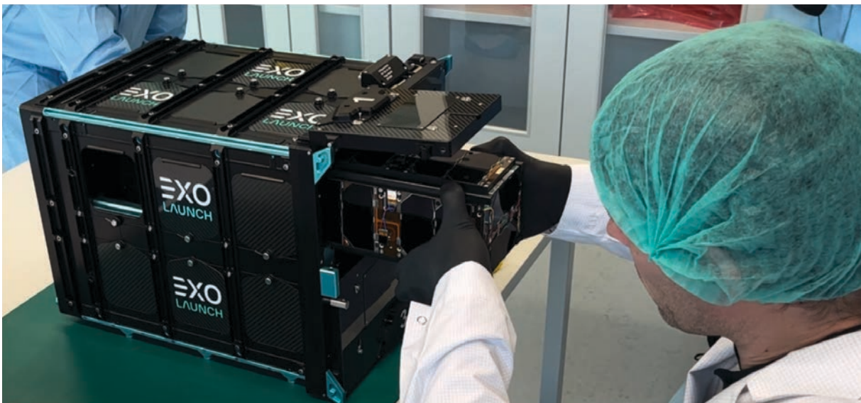
Satellite en cours d'intégration dans le système de séparation lanceur – février 2023.
