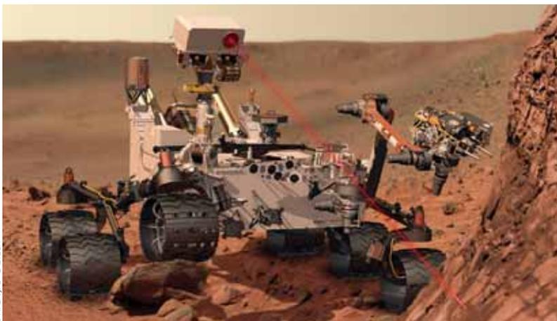
► L'instrument ChemCam du rover Curiosity effectue des tirs laser afin d'analyser la composition du sol martien.
